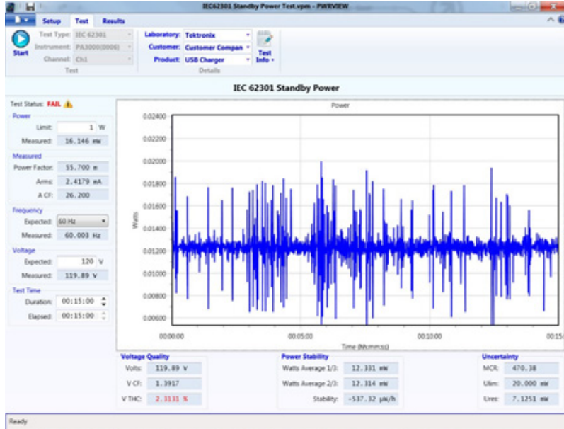
그림 56: 전체 컴플라이언스 IEC 62301 대기 전력 테스트
